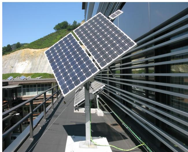
Los Paneles solares del generador están montados sobre una estructura de perfil tubular cuadrado (PTR), en forma de balancín para su fácil transportación, el panel se puede colocar desde 90° hasta 180°, de inclinación para poder manejar diferentes ángulos con respecto a la posición del sol y tener mediciones más claras, así mismo para sujetar el panel al balance es mediante un sistema de riel de aluminio de 105 mm para montaje de paneles, soporte frontal con
